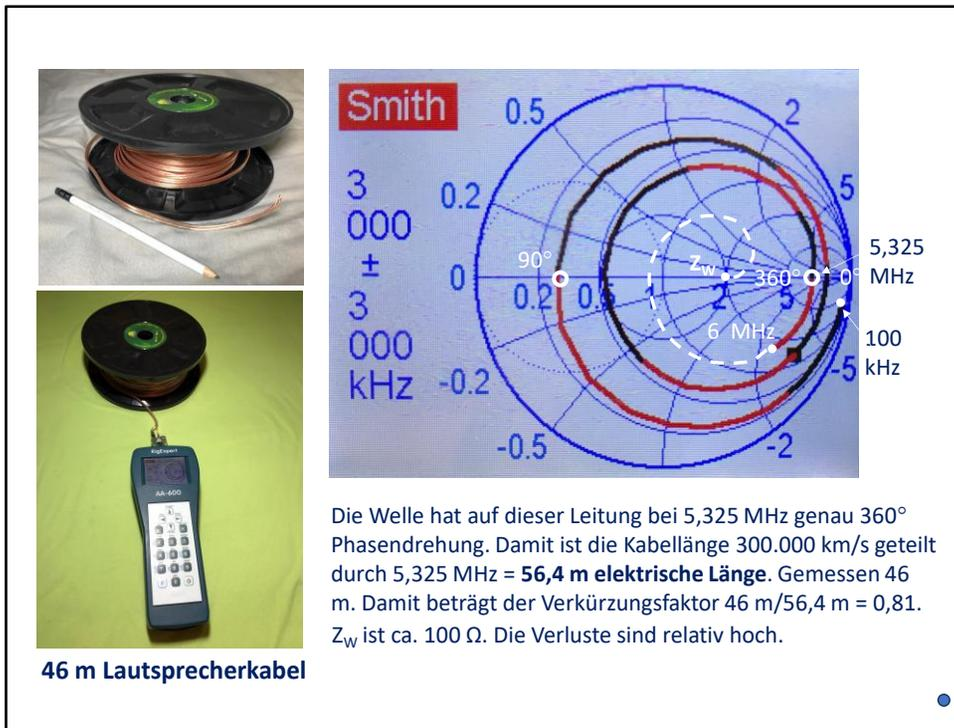
Normalerweise müsste bei einer idealen Leitung die Ortskurve immer auf dem äußeren Kreis laufen. Hier sehen wir eine reale Leitung, mit ziemlich viel Dämpfung (enger werdende Spirale). Je schneller die nach innen geht, desto größer ist die Dämpfung. Würde die Messfrequenz weiter erhöht, würde man sehen, dass die Spirale offensichtlich auf den realen Punkt 2 zuläuft (gestrichelte weiße Linie). Das heißt der Wellenwiderstand dieser Leitung beträgt ca.  $50 \Omega * 2 = 100 \Omega$ .
