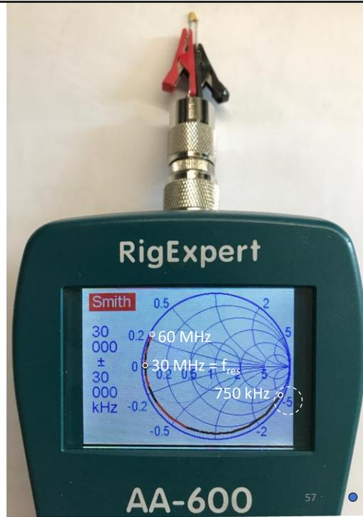
Man kann hier nachrechnen: bei 750 kHz beträgt der Blindwiderstand des 860 pF-Kondensators  $-j 246 \Omega$ . Das entspricht normiert (geteilt durch  $50 \Omega = -j 4,92$ ). Im Bild sieht man, dass die Ortskurve etwas unterhalb des Blindwiderstandes  $-j 5$  beginnt.
